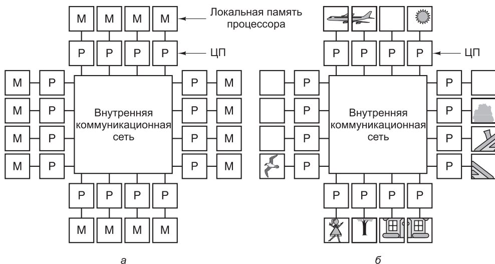
Рис. 8.18. Мультикомпьютер из 16 процессоров, каждый из которых имеет собственную память (а); битовая карта изображения с рис. 8.16, разделенная между 16 модулями памяти (б)
