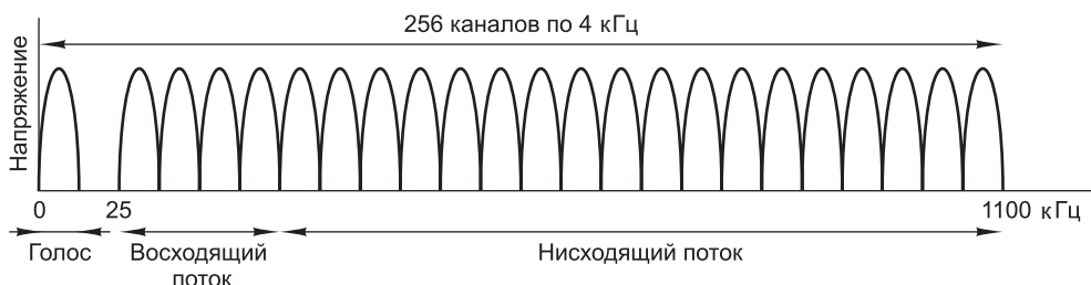
Рис. 2.35. Функционирование ADSL
