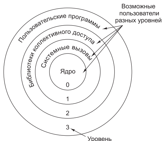
Рис. 6.15. Уровни защиты процессора Core i7
