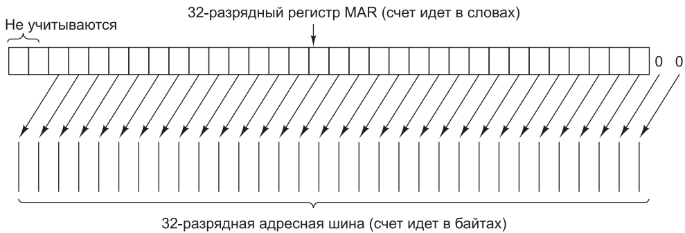
Рис. 4.3. Распределение битов регистра MAR в адресной шине
