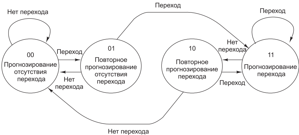
Рис. 4.29. 2-разрядный конечный автомат для прогнозирования переходов
