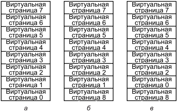
Рис. 6.6. Ситуация, в которой алгоритм LRU не работает
